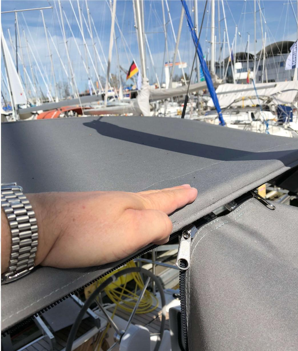
3. Wenn der Wetterschutz **entfernt** wird, bitte **erst** an der **Bimini** den Reißverschluss öffnen und anschließend an der Sprayhood.
