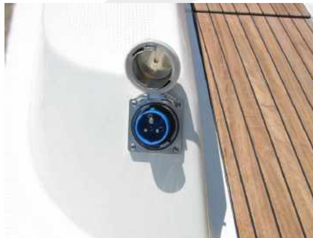
Deckel durch Linksdrehung entriegeln und öffnen
