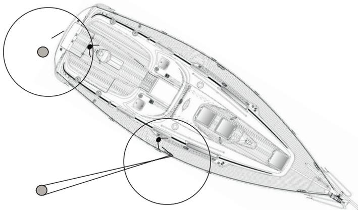
Wenn das Heck frei am Dalben vorbeikommt gibt der Rudergänger das Kommando „Festhalten der Slipleine“ und das Boot dreht bei hart eingeschlagenem Ruder um den so entstandenen Drehpunkt.
